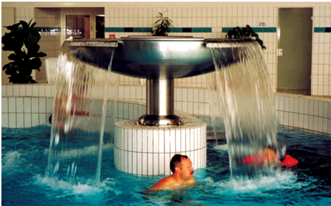
Wasserkelch Typ Goch – aus Edelstahl 1.4571, 2 m Ø mit 4 Überläufen am Umfang. Säulenlänge ca. 2,5 m, alternativ: kürzer auf Betonsockel. Wasserbedarf ca. 150 m 3 /h.
