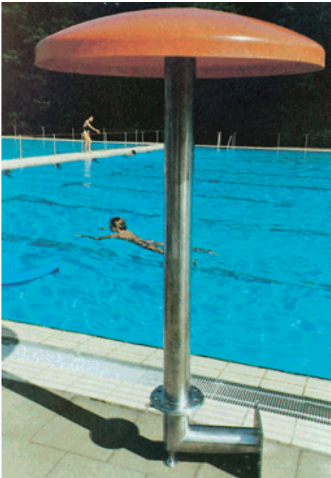
Wasserpilz Nr. R 8214/1000 Ø aus Edelstahl und GfK, Standsäule 114 mm Ø, 1600 mm hoch, Haube 1000 mm Ø, Wasserbedarf min. 40 cbm/h. Abb. mit Bodeneinbauteil Nr. R 8214 E/DN 100 aus Edelstahl.
