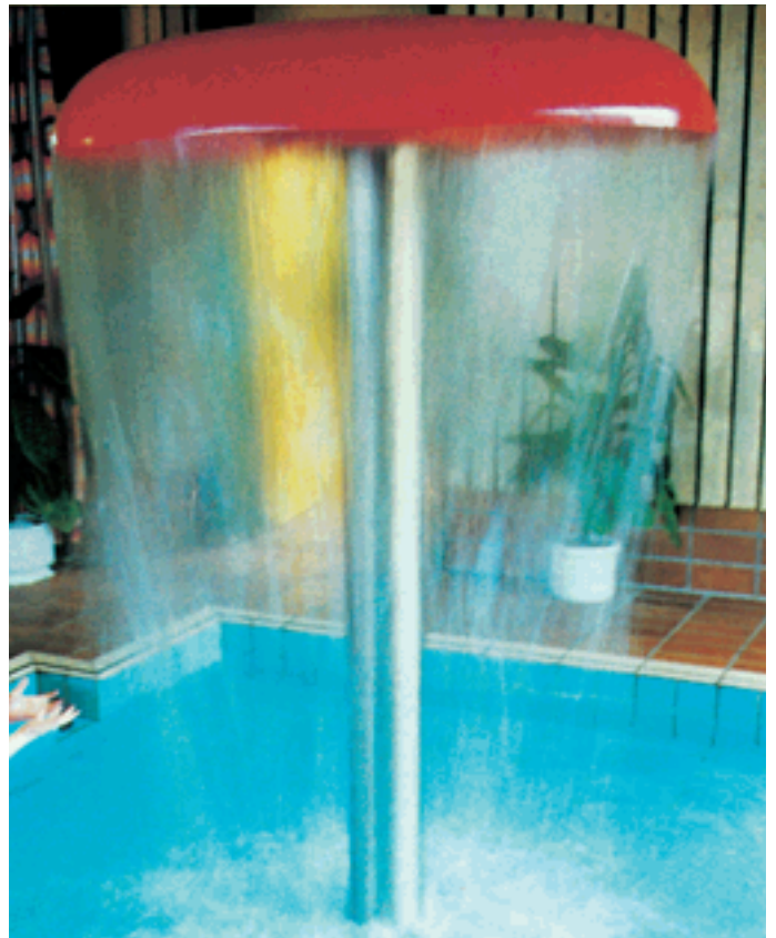
Wasserpilz Nr. R 8515/1300 aus Edelstahl und GfK, Standsäule 168 mm Ø, 2,20 m hoch, Haube 1,30 m Ø mit speziellem Wasserberuhigungsbecken für optimalen Überlauf, mit Fußflansch DN 150.
