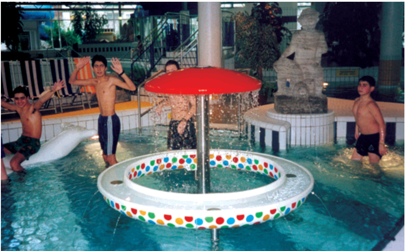
Schiffchenkanal aus GfK und Edelstahl, weiß mit bunten Punkten. Das Wasser wird durch Öffnen eines Schiebers mit Handrad in die Rinne geleitet und strömt durch spezielle Düsen im Kreis herum. Überlauföffnungen außen an der Rinne sind ein zusätzlicher Effekt und halten gleichzeitig den Wasserstand. Abmessung: 1,9 m Ø x 1,35 m, Höhe ca. 0,6 m. Abb. in Kombination mit Wasserpflanz 1,0 m Ø.
